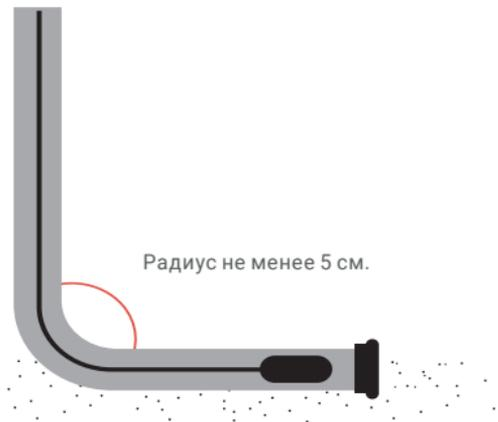
5. Заполните штробу в полу с уложенной гофрированной трубой клеевым раствором и отметьте место расположения датчика на поверхности пола и на схеме укладки.
